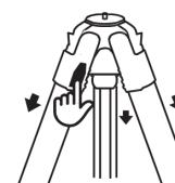
②石突きのロックボタンを押して脚を取り外し、本体と石突きを取外します。
